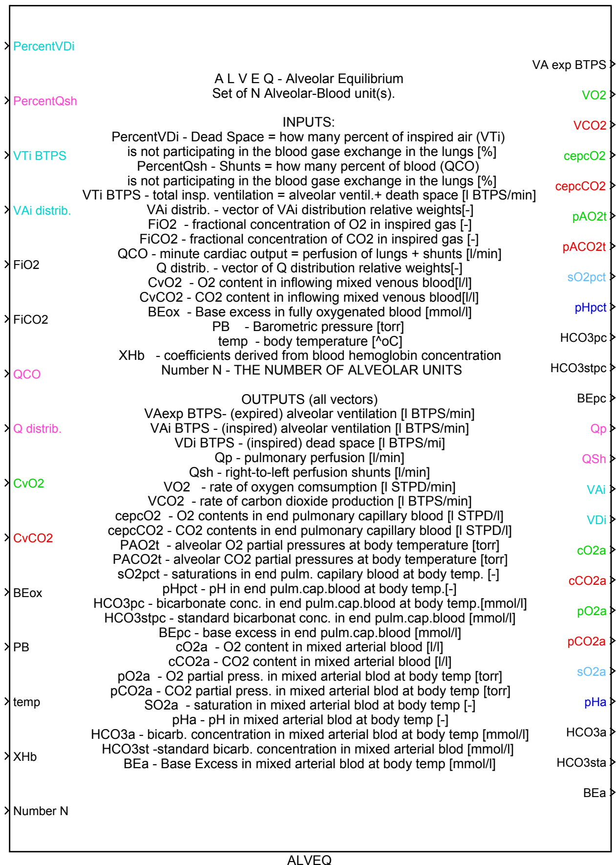
Obr. 34 – Simulační čipy mají hierarchické uspořádání a pokud to jde, skrývají před uživatelem implementační detaily. V masce jsou uvedeny názvy vstupů a výstupů. Na následujícím obrázku je naznačena vnitřní struktura simulačního čipu ALVEQ z knihovny PHYSIOLIBRARY, kterou lze stáhnout z http://physiome.cz/simchips .
