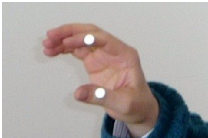
Obrázek 2 — Umístění pasivní značek na ruce
